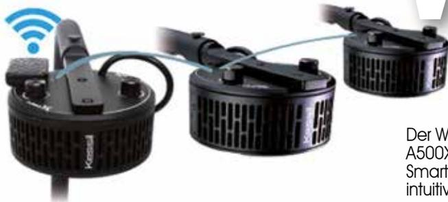
Der WiFi Dongle von Kessil® wird in den K-Link-Anschluss einer Kessil® A360X oder A500X Leuchte eingesteckt und ermöglicht zusammen mit einem Android / iOS Smartphone die effiziente Fernsteuerung einer Vielzahl von Funktionen über die intuitive Kessil® App.
