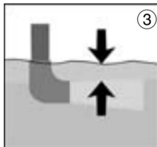
(3) Auslauf ist zu tief, die gesamte Wassermenge über der Auslauf-Oberkante fließt zurück!
