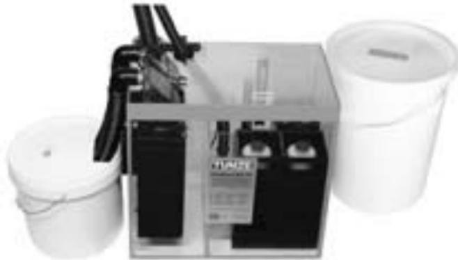
Über den Ablauf wird das Aquarienwasser in die erste Kammer des Filters geleitet. Dabei reduziert sich die Wassergeschwindigkeit und der anfallende Schmutz wird vom Comline DOC Skimmer oder Comline Filter aufgenommen. In diesem Bereich könnte man noch Regelheizer oder Sonden platzieren.
