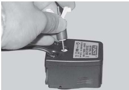
3. Lager aus Motor und Kreiselgehäuse entnehmen. Bei festem Sitz mit Hilfe der Antriebswelle von außen herausrücken; Lager sind baugleich -> keine Verwechslung möglich!
