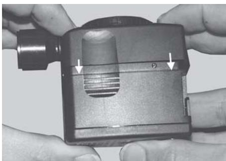
6. Kreiselgehäuse parallel zum Motorblock aufsetzen und festdrücken.
