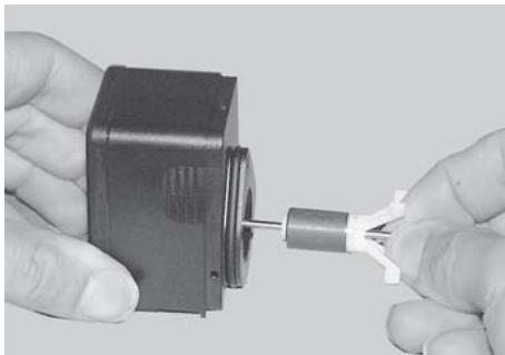
2. Läuferbaugruppe aus Motorgehäuse entnehmen.
