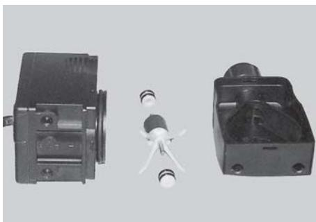
4. Alle Teile gründlich mit Kunststoffbürste reinigen; bei harten Verkrustungen in Essiglösung legen, danach gründlich mit Wasser abspülen. Alle Teile auf Verschleiß und Beschädigungen prüfen, bei Bedarf ersetzen.
